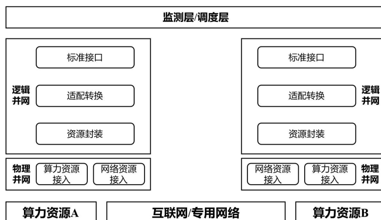
图 1 算力并网功能架构图
